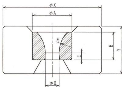
電縫鋼管材料又は良好な外面仕上を必要とする硬質管引きに適しMB・
