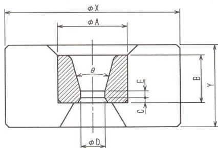
鋼管用フローティングダイスでFB型FP型プラグと併用しております。
