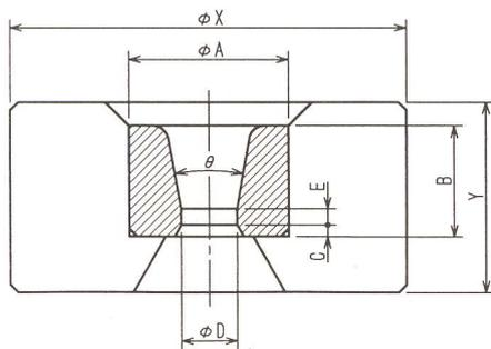
主としてアルミ及びアルミ合金の管引きに適しMP型プラグの併用を標準としております。
